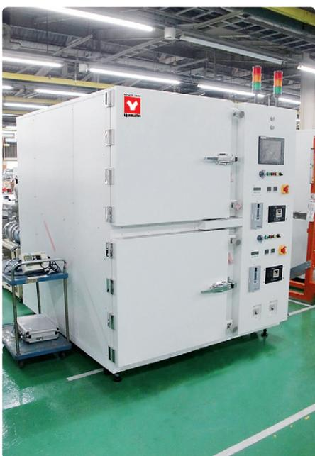
**用途：电池制造工程中，为了去除电极材料中的水分、溶剂进行真空干燥。**
