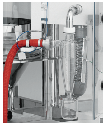
在旋风分离器配置有防止烫伤的安全盖及除静电刷。
